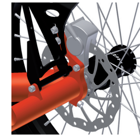
Hydraulische Scheibenbremsen (Option) Hydraulic disc brakes (optional)
